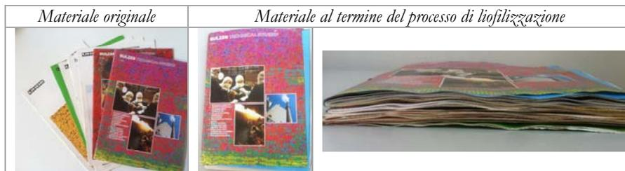
Figura 6. Effetto della liofilizzazione sull'aspetto esteriore di un insieme di brochure patinate (campione 4) sottoposto al processo dopo allagamento (simulato)
