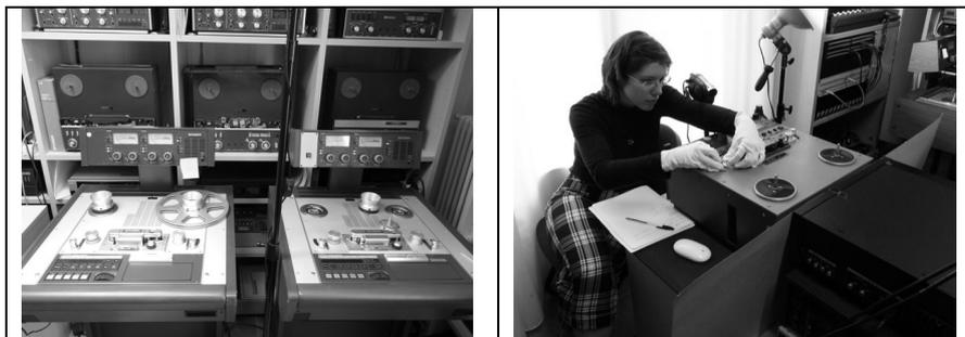
Figura 2. A sinistra: due dei tre esemplari di STUDER A-812 del laboratorio per la conservazione e per il restauro dei documenti sonori presso l'archivio storico della Fondazione Arena di Verona. A destra: un momento del processo di ri-mediazione (trasferimento del segnale → regolamento del sistema → equipaggiamento di lettura, v. sezione 2.7).
