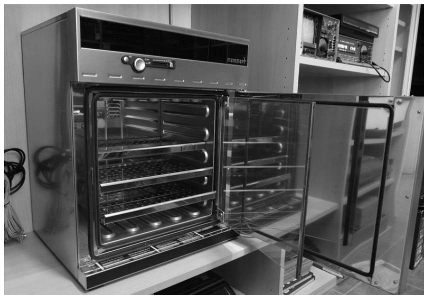
Figura 14. Incubatore di precisione utilizzato per il trattamento termico dei nastri magnetici affetti da SBS-SSS (v. anche paragrafo 2.3).
