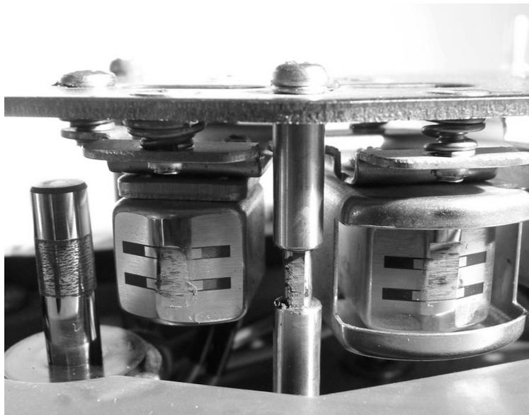
Figura 12. Un dettaglio delle testine di lettura del magnetofono TEAC X-20R dopo la lettura di un nastro con evidenti sintomi di SBS-SSS. Il residuo che si osserva sulle testine è costituito da una parte dello strato superiore del nastro magnetico che si è accumulato durante la lettura a causa dell'attrito tra le testine e il nastro stesso. Le analisi descritte in questo articolo hanno dimostrato che il residuo contiene anche particelle magnetiche, quindi vi è una perdita di informazione audio.
