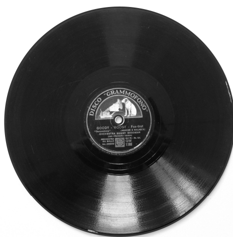
Figura 7. Rilevamento automatico dei contorni del disco e del foro centrale. In questo caso, la deviazione tra i centri delle due circonferenze è di 0,31 cm
